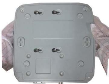
4 Drehen Sie die Oberseite des Gerätes nach unten, und drehen Sie die Schrauben fest ein.
