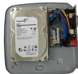
3 Richten Sie die Festplatte mit den vier Bohrungen im Boden aus.
