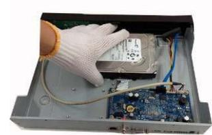
1 Lösen Sie die Schrauben an der oberen Abdeckung und an der Seitenverkleidung.
