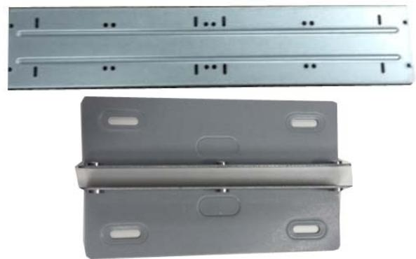
2 Nehmen Sie die Unterseite der Festplattenhalterung und der CD-ROM-Halterung ab.
