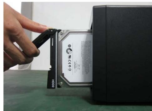
1 Schrauben Sie die Festplatte mit 4 Schrauben an.
