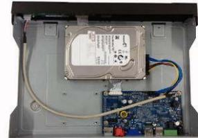
4 Drehen Sie die Oberseite des Gerätes nach unten, und drehen Sie die Schrauben fest ein.
