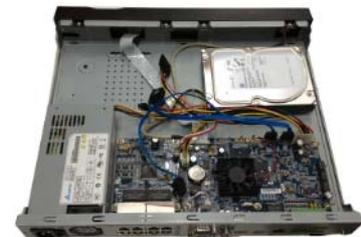
1 Lösen Sie die Schrauben an der oberen Abdeckung und an der Seitenverkleidung.
