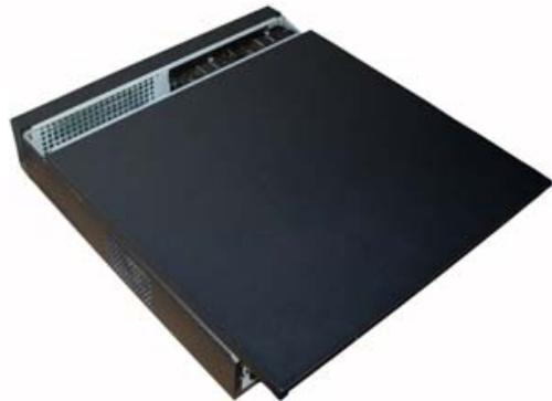
1 Mit einem Schraubendreher lösen Sie die Schrauben an der Rückplatte, dann entfernen Sie die Frontabdeckung.
