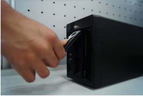
3 Ziehen Sie den Festplattenknopf hoch, wenn Sie die Festplatte in das Gehäuse setzen, der Verschluss kommt ansonsten mit der Frontblende in Berührung.
