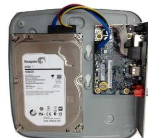
6 Verbinden Sie das Festplattenkabel und Netzkabel.
