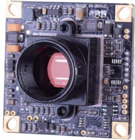
**Ultrahochaufl. 1/3" Farb-WDR-T/N-Platinenkamera**
