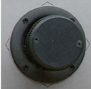
Durch die Bewegung des Joysticks nach rechts, links, oben und unten drehen sich Schwenk-/Neigekameras in die entsprechende Richtung.
